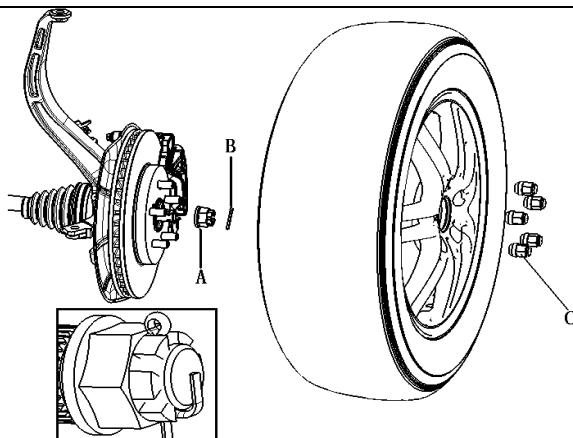
7 清洁制动盘与前轮的配合面，然后使用车轮螺母，安装前轮。
